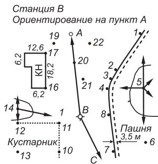
Рис. 7.8. Пример абриса тахеометрической съемки: 1–22 – ременные точки
