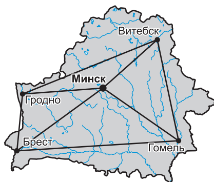
Рис. 1.15. Схема высокоточной геодезической сети (ВГС) Республики Беларусь
