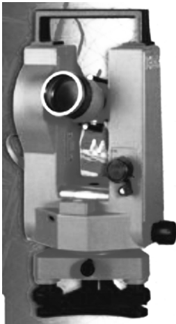
Рис. 4.12. Теодолит 3Т2КП (или 3Т5КП): точность 2'' / 5'' ; увеличение зрительной трубы 30\times ; минимальное расстояние визирования 0,9 м; диапазон работы компенсатора вертикального круга 4' / 5' ; масса 4,1 / 5 кг
