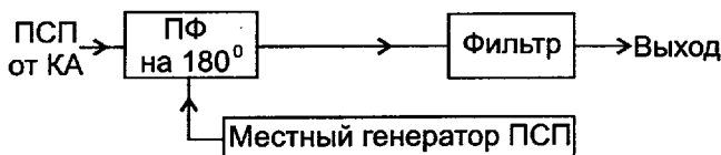
Рис. 8. Выделение немодулированного несущего сигнала
